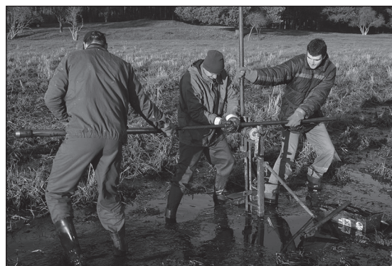
Bas Wiercenie rdzenia w terenie bagnistym
